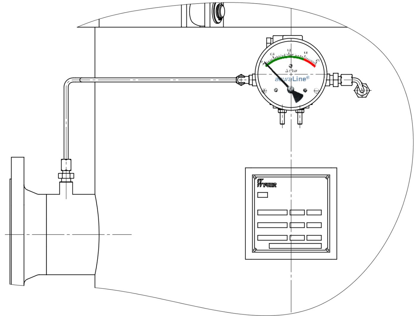
Differenzdruckanzeiger DFA (Abb. mit MG1)
